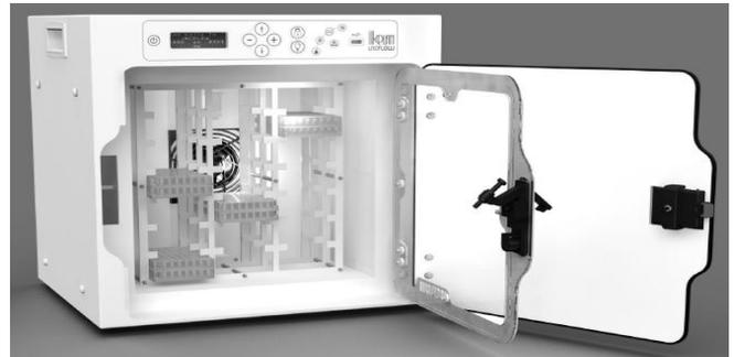
L'incubateur se pilote grâce aux boutons de sa face avant permettant à l'opérateur de saisir les paramètres de fonctionnement : température, concentration en  $\text{CO}_2$  et  $\text{O}_2$ , cycle de fonctionnement, etc.
